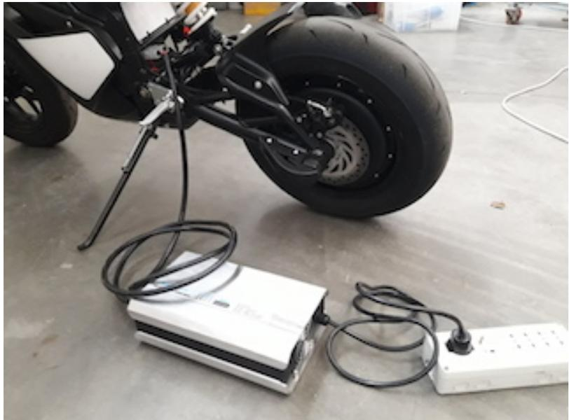
oppure in una stazione di ricarica remota, fornita come optional per chi ha più di una batteria. Ogni caricabatterie assorbe 1700W a 230V.
